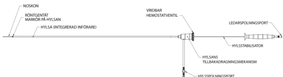
Figur 3. Schematisk bild av införingskatetern för aortakroppen från Ovation iX abdominellt stentgraftsystem
