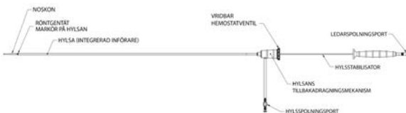
Figur 5. Schematisk bild av införingskatetern för TriVascular Ovation iX Iliakaliskt stentgraft
