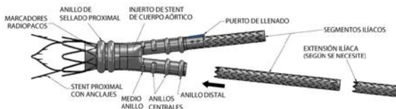
Figura 1. Esquema del sistema de injerto de stent abdominal Ovation Prime de TriVascular desplegado
