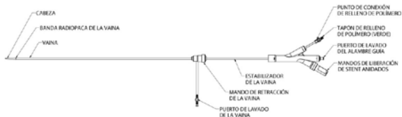
Figura 2. Esquema del catéter de colocación del sistema de injerto de stent abdominal Ovation Prime de TriVascular
