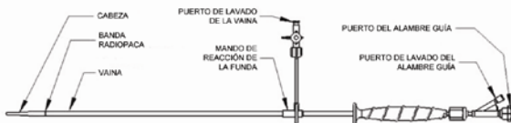
Figura 2. Esquema del catéter de colocación del cuerpo aórtico del sistema de injerto del stent abdominal Ovation de TriVascular
